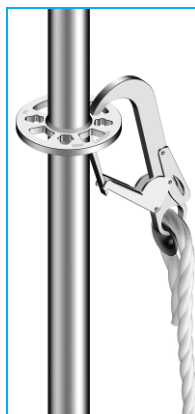
Detailní obrázek zajištění pracovníka na kotouči stojny
