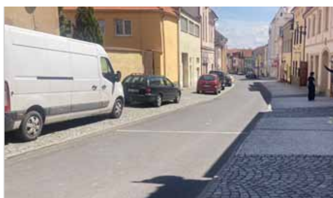
Česká ulice, Louny příklad organizace dopravy v površích vedoucí k parkování na chodníku - pojízdná vozovková dlažba by měla být v celé šíři chodníku vždycky jen v místě vjezdu samotného. Kromě šíře vjezdu by nikdy neměla zasahovat až k fasádám domů – podél fasád by vždy měl zůstat chodník
