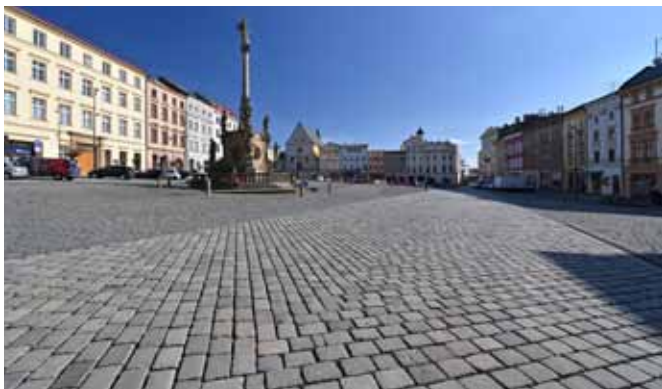
Dolní náměstí, Olomouc příklad organizace dopravy a funkcí různými formáty a způsoby kladení dlažeb - plocha zároveň tvoří jeden soudržný celek
